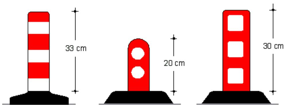
Gli elementi prefabbricati per salvagenti pedonali e **delimitatori di corsia** possono essere realizzati in calcestruzzo, costituiti da sezioni componibili mediante appositi incastri. Essi devono essere impiegati solo nelle
